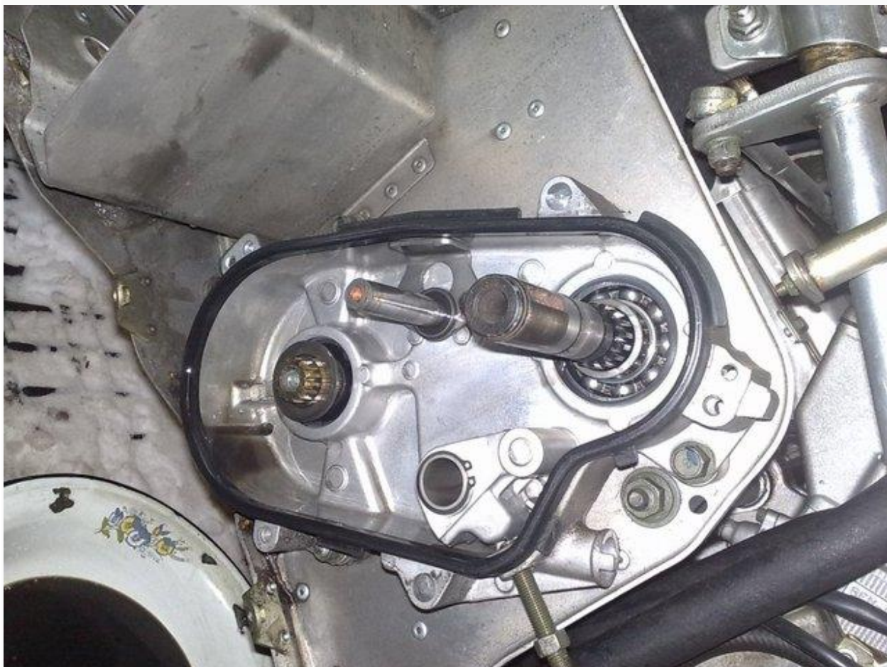
Снимаем картер коробки
