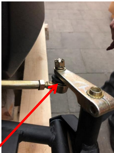
Установка рулевых тяг.
