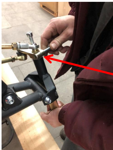
Регулировка рычагов рулевой стойки и их фиксация при помощи болтов М8х40.
