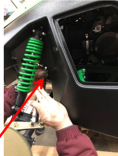
Установка реактивных тяг
