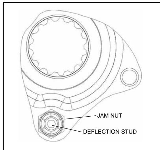
1. Loosen the jam nut.
