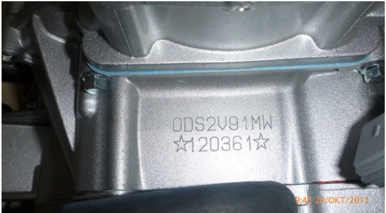
Номер двигателя выбит на левой половине картера.
