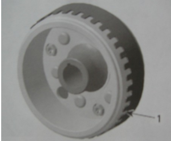
1 - ротор магнето с триггером колеса
